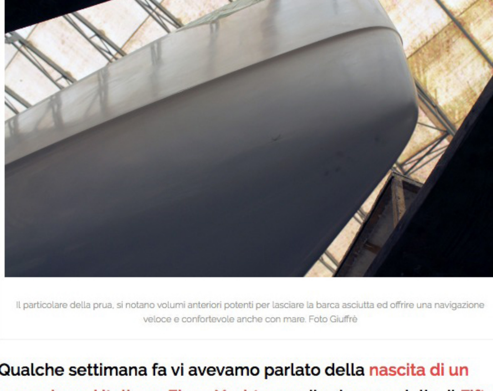
Il particolare della prua, si notano volumi anteriori potenti per lasciare la barca asciutta ed offrire una navigazione veloce e confortevole anche con mare. Foto Giuffrè
